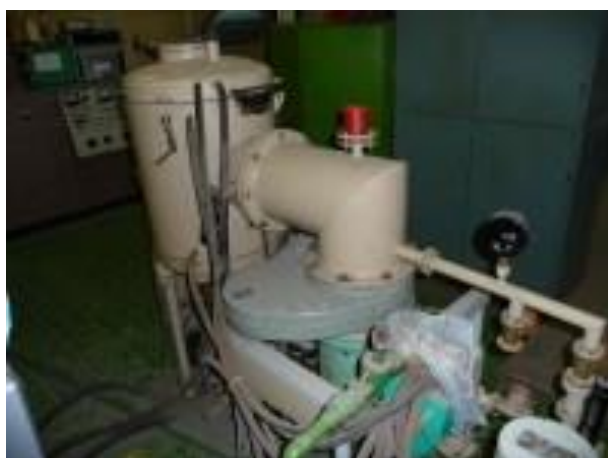
Рисунок 2.2 - модернизированная вакуумная шахтная электропечь сопротивления СШВ-1.2,5/25-И1
